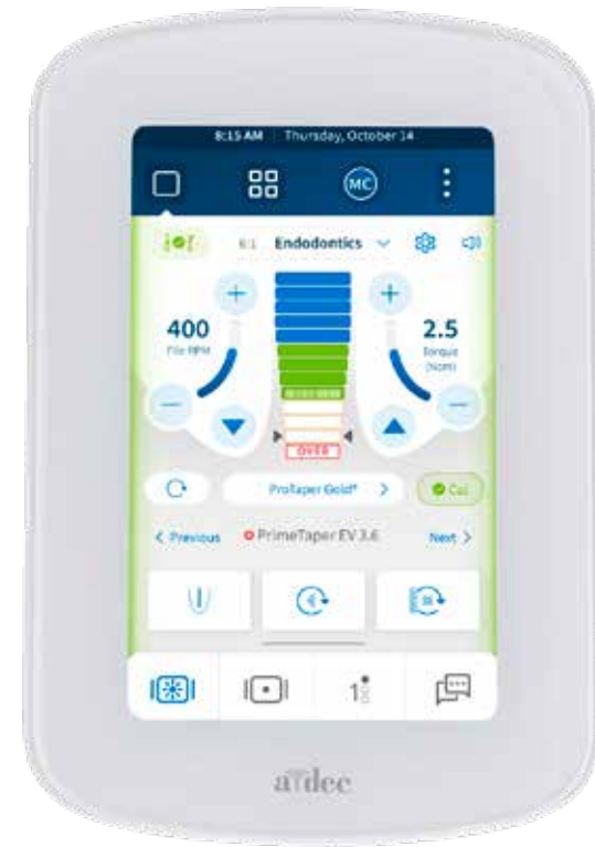
Le localisateur d'apex Midwest intégré repère avec précision et affiche la position de la lime par rapport à l'apex du canal sur l'écran tactile DS5 pendant que vous travaillez.
